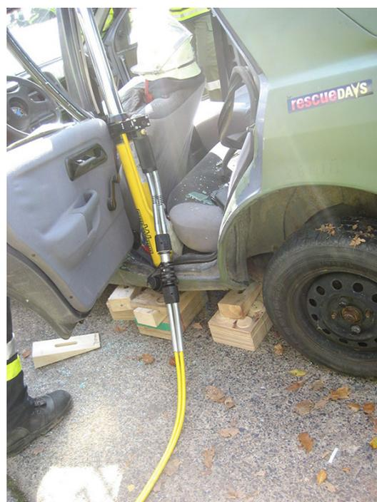
A partir de ahora los RAMS de Weber tendrán marcas en el pistón que indicarán la distancia remanente dentro del cilindro. Esto tiene como objeto que el operador conozca de antemano hasta adonde va a poder deformar la pieza antes que le haga tope.
